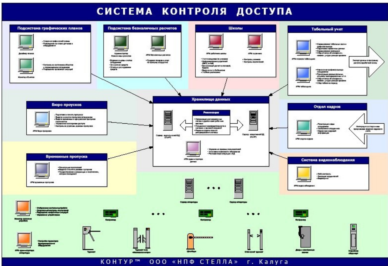
Рис.1 Структурная схема системы контроля доступа КОНТУР
